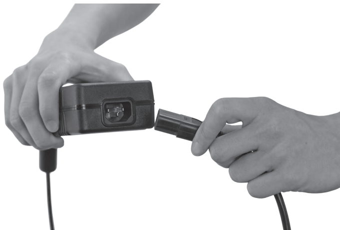
Abb. 12: Kaltgerätekupplung in Kaltgeräteeinbaustecker stecken
