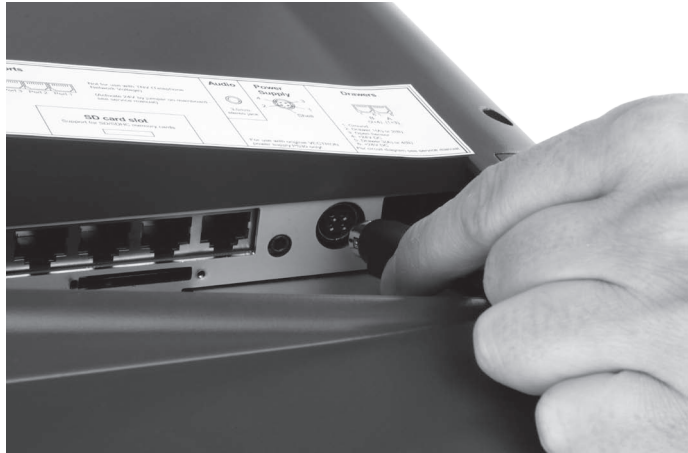
Abb. 23: Stromleitungsstecker aus Stromanschluss ziehen
