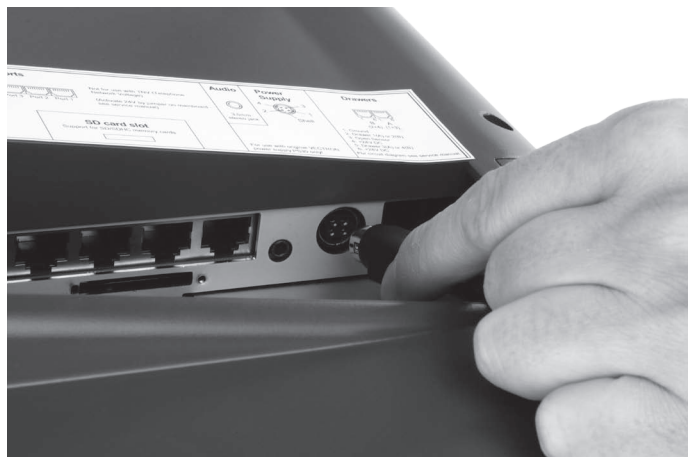
Abb. 11: Stromleitungsstecker in Stromanschluss stecken
