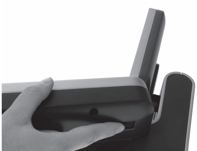
Abb. 21: Mini II aus- und einschalten
