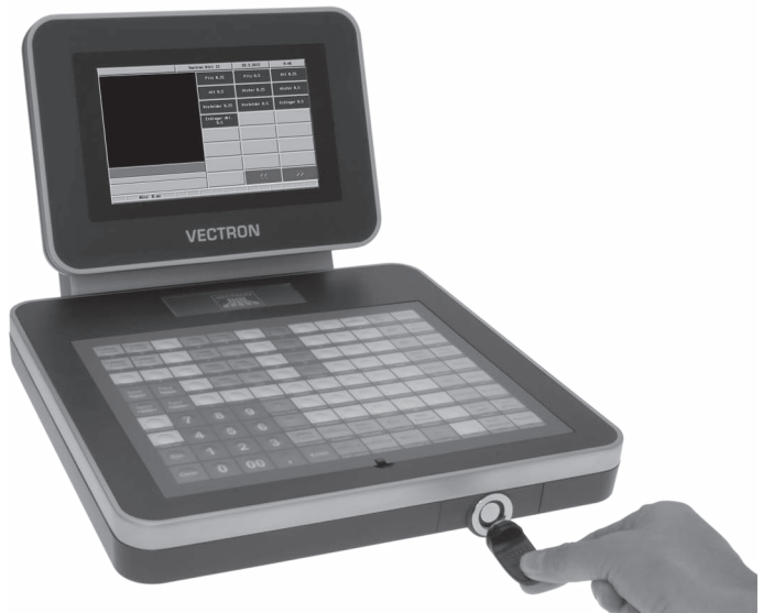
Abb. 19: Schlüssel an das Schloss halten
