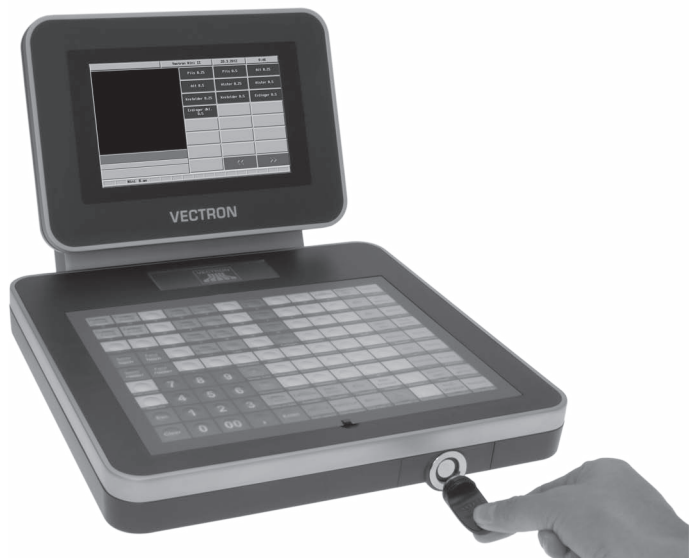
Abb. 20: Schlüssel an das Schloss halten oder vom Schloss abziehen
