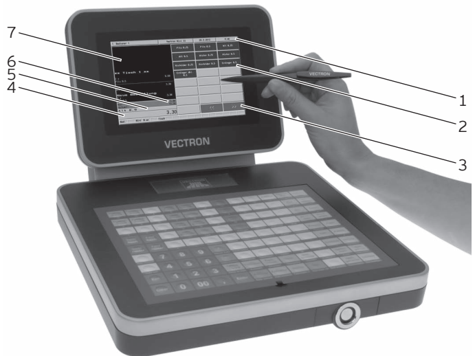
Abb. 18: Daten über den Touchscreen eingeben
