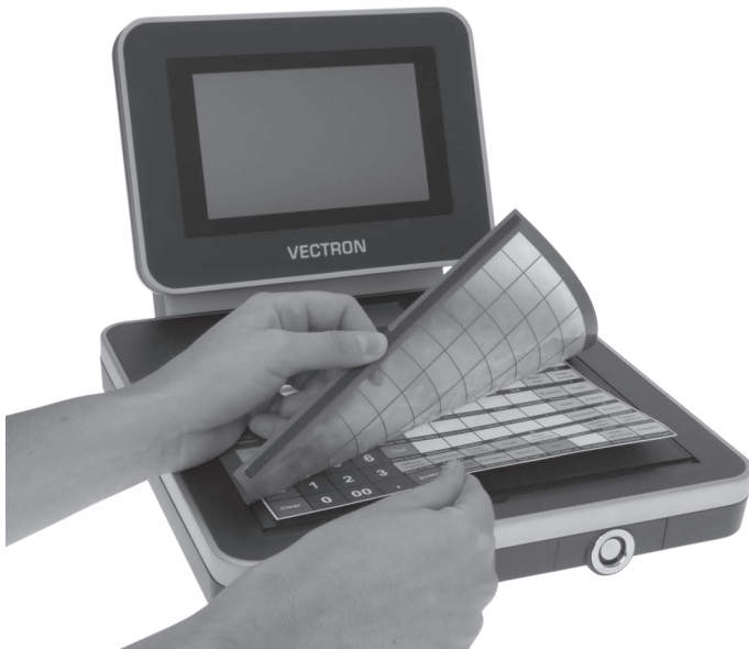
Abb. 13: Folientastatur anheben und Einlegeblatt ausrichten
