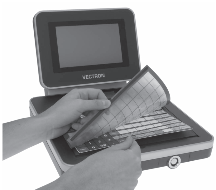
Abb. 25: Folientastatur anheben und Einlegeblatt ausrichten
