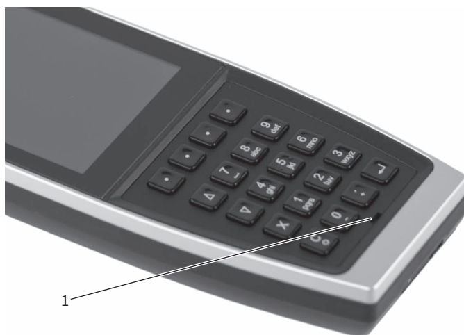
Abb. 29: Kerbe im Tastenführungsgitter
