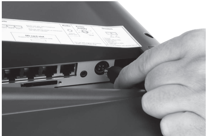
Abb. 11: Stromleitungsstecker in Stromanschluss stecken
