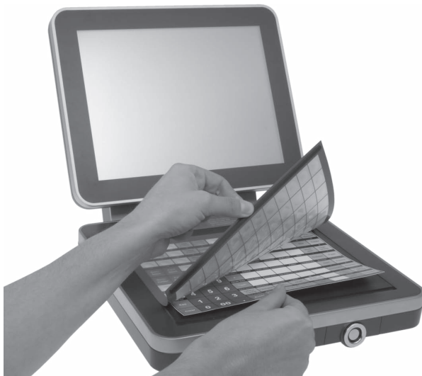
Abb. 25: Folientastatur anheben und Einlegeblatt ausrichten
