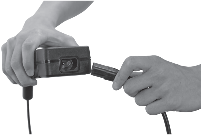
Abb. 24: Kaltgerätekupplung aus Kaltgeräteeinbaustecker ziehen
