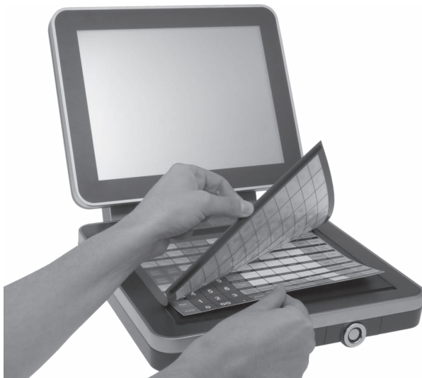
Abb. 13: Folientastatur anheben und Einlegeblatt ausrichten
